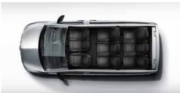
Vito Tourer Compact con panca lato passeggeri anteriori, panca a 3 posti con sedile esterno ripiegabile nella prima fila e panca a 3 posti nella seconda fila del vano passeggeri.
