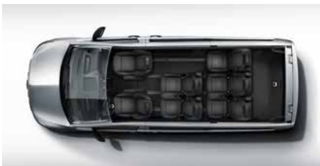
Vito Tourer Extralong con panca a 2 posti nella prima fila e panca a 3 posti nella seconda fila del vano passeggeri, sistema di guide con bloccaggio rapido nel vano passeggeri.
