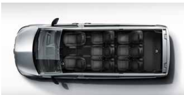
Vito Tourer Extralong con panca a 3 posti con sedile esterno ripiegabile nella prima fila e panca a 3 posti nella seconda fila del vano passeggeri.
