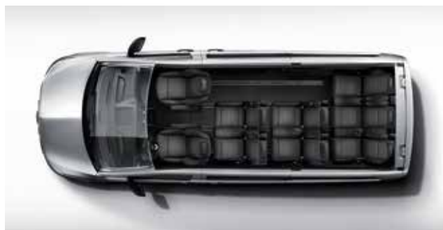
Vito Tourer Extralong con panca a 2 posti nella prima fila, panca a 2 posti nella seconda fila e panca a 3 posti nella terza fila del vano passeggeri.
